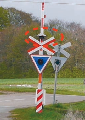
Auf dem Foto ist die Signalglocke rot umkränzt.
