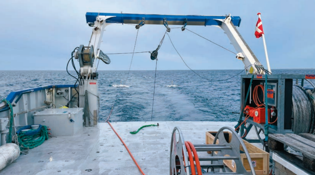
Die Technik wird hinter dem Schiff hergezogen und scannt den Meeresboden – und die Erdschichten, die darunter liegen.
