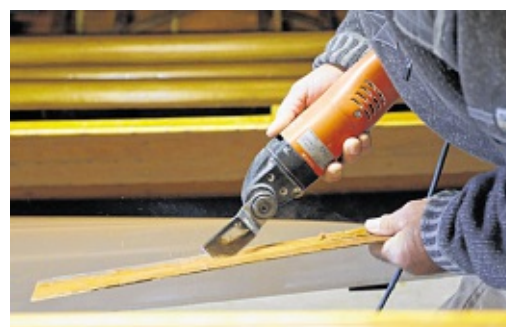
Mit einer Spezialsäge wird eine Mahagonileiste durchtrennt. Sie soll in den aufgefrästen Riss am Rumpf des Bootes eingelassen werden.
