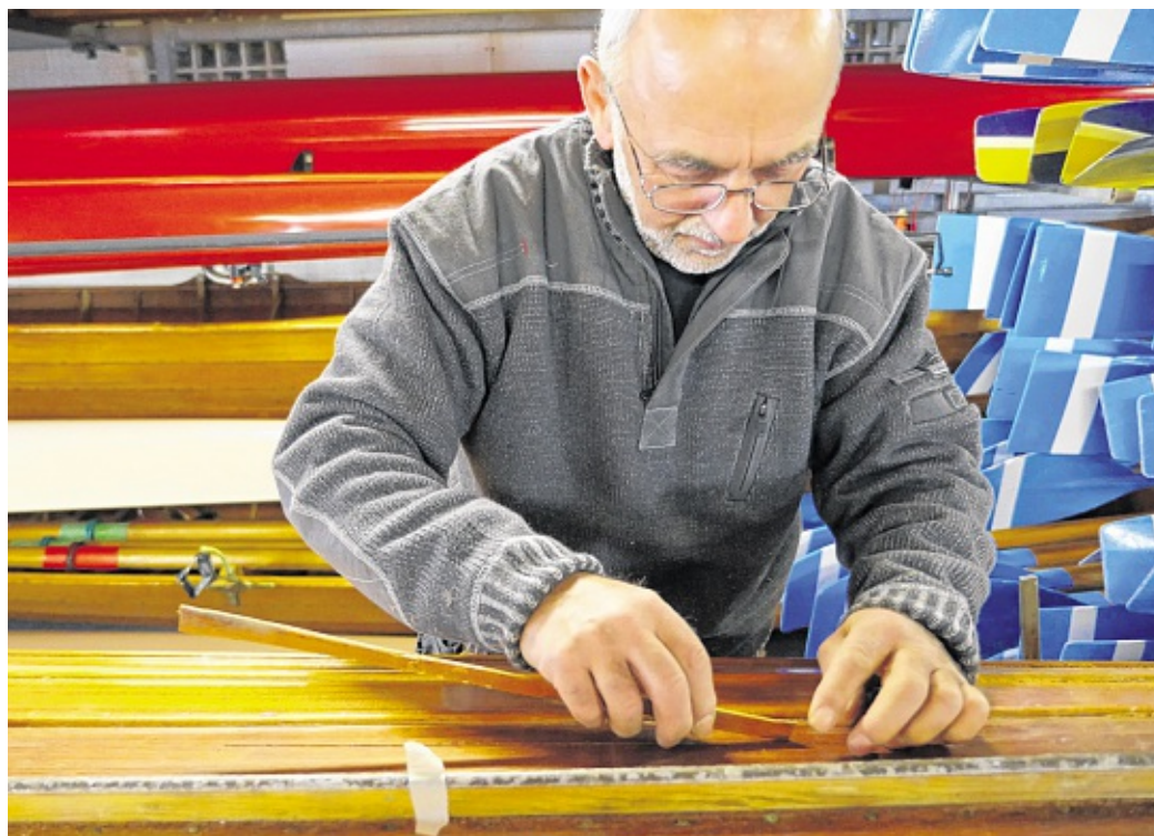
Mit sicherer Hand fräst Bootswart Uwe Petersen mit Spezialwerkzeug einen Schaden am Rumpf auf.
