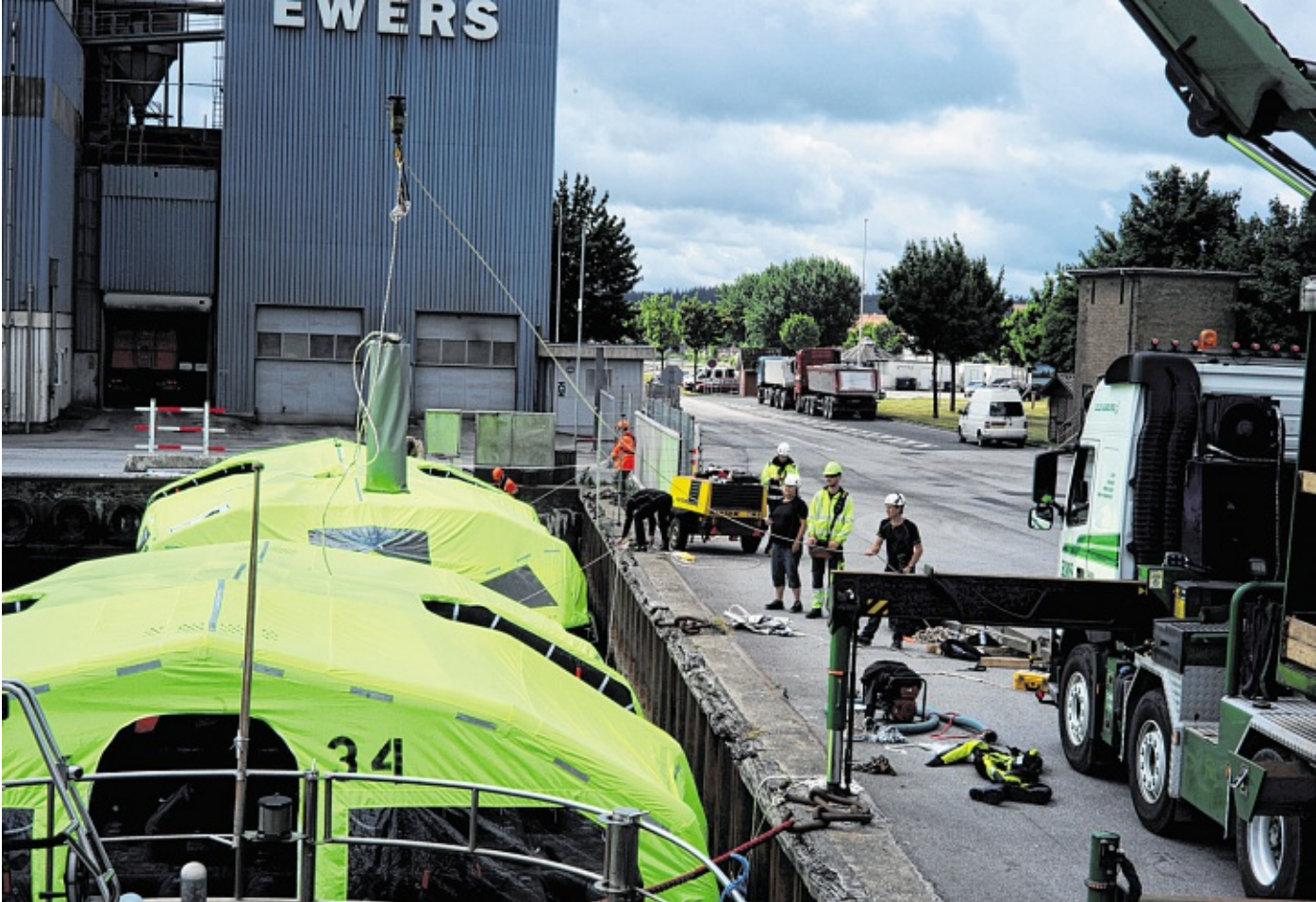
Aus fünf Metern fällt der Dummy auf die Rettungsinsel. Während die eine Insel im Gammelhavn getestet wurde, fuhr eine zweite zur Erprobung auf die Förde.
