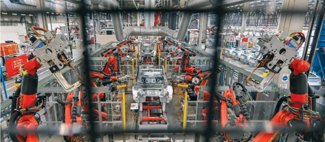
Roboter verschweißen die Karosserie eines Elektrofahrzeuges vom Typ Model Y.
