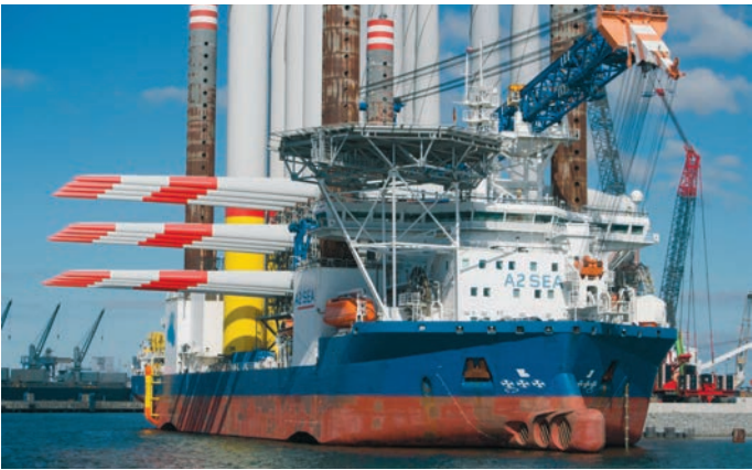
Hubschiff mit Bauteilen für Windkraftanlagen
